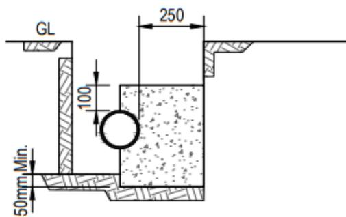
HORIZONTAL THRUST BLOCK FOR BENDS - ELEVATION
